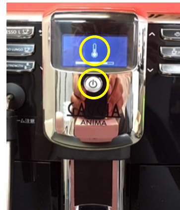
③本体の電源を入れます 自動すすぎ終了後、温度計の マークが消えたら準備完了です
