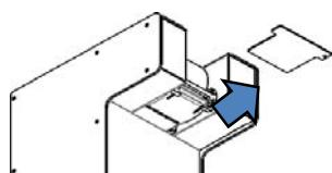
① 製氷皿下部のカバー固定ボルトを緩め、カバーを取り外してください。
